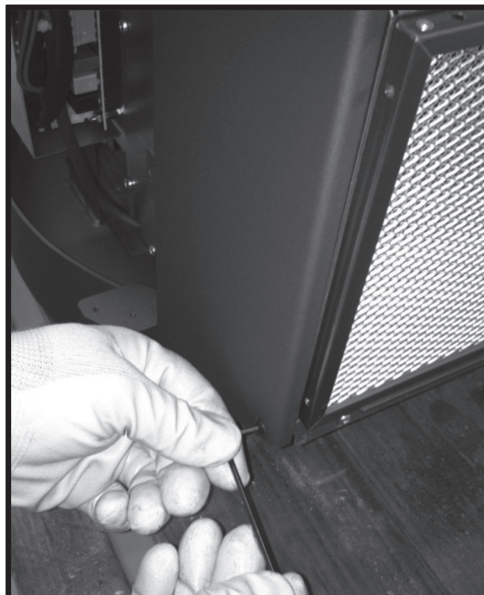
Photo 10 : Retirer la vis inférieure comme indiqué
