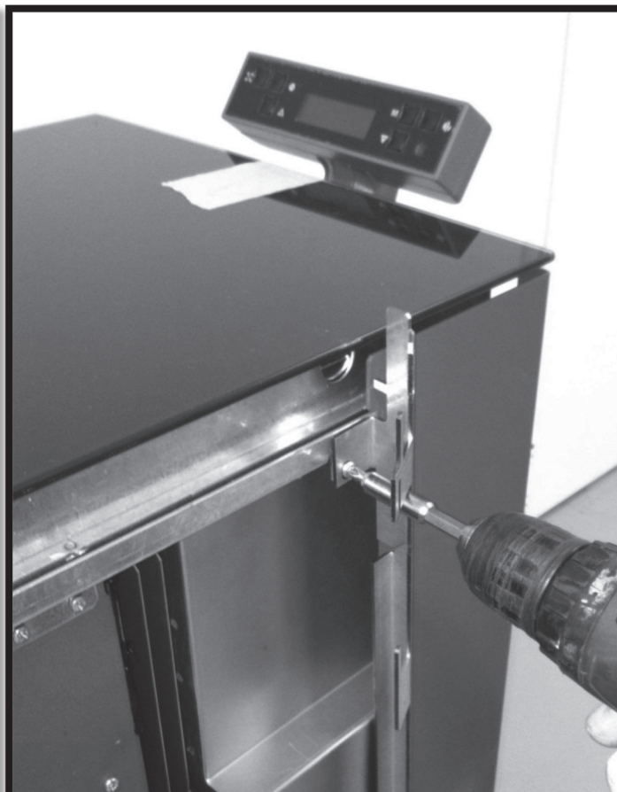
Photo 7 : Retirer les 2 vis qui fixent le profil
